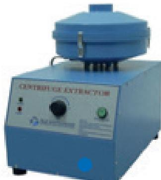
**Centrifuga estrattrice con filtro:** necessaria per determinare il contenuto di bitume nel conglomerato, in conformità alla normativa UNI EN 12697-1 e ASTM D2172.
