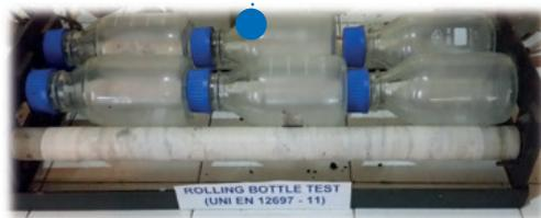
**'Girabottiglie' per Rolling Bottle Test:** necessario per realizzare test di adesione bitume-inerti in conformità alla normativa europea EN 12697-11.
