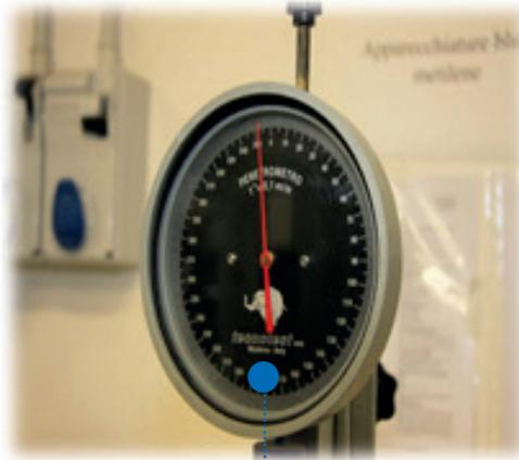
**Penetrometro:** necessario nel determinare il grado di penetrazione del bitume, in conformità alla normativa europea UNI EN 1426, al fine di assegnare la classe di appartenenza del bitume.
