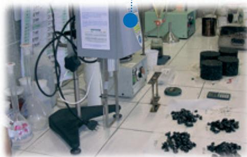
**Viscosimetro Brookfield:** permette di misurare la viscosità di un fluido, ovvero quantifica la resistenza dei fluidi allo scorrimento, in conformità alla normativa internazionale ASTM D 2196.
