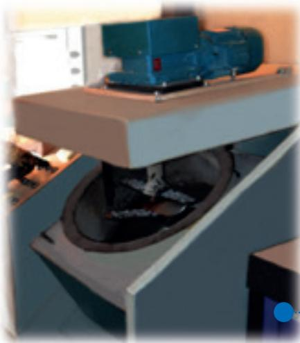
**Mescolatore automatico da laboratorio:** mescolatore con regolazione elettronica della temperatura e della velocità di miscelazione, permette di riprodurre il mescolatore di impianto del conglomerato bituminoso, come prescritto dalla norma UNI EN 12697-35, registrando gli assorbimenti energetici.
