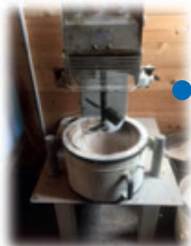
**Mescolatrice planetaria per asfalti:** utile per la produzione di piccole quantità di conglomerato bituminoso in conformità dalla norma UNI EN 126 97-35.
