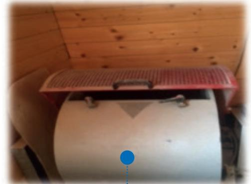
**Macchina Los Angeles:** utile nella determinazione della resistenza alla frammentazione degli aggregati lapidei, in conformità alla norma UNI EN 1097-2, e di provini di conglomerato bituminoso.
