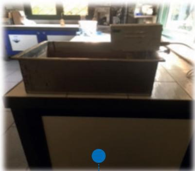
**Bagno termostatico chiuso ad acqua:** utile per la conservazione in acqua dei provini Marshall e per i provini di catrame, come prescritto dalle norme UNI EN 12697-34, ASTM D1559, D5581.
