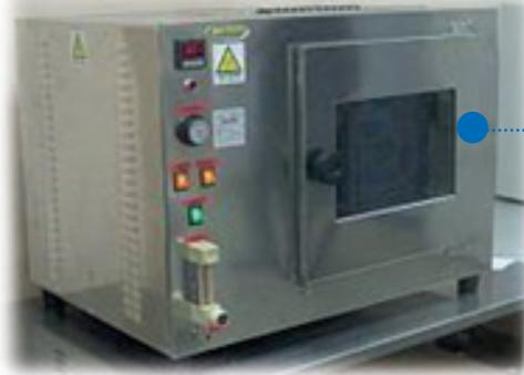
**Pressure ageing vessel (PAV):** necessario nel determinare l'invecchiamento a lungo termine del legante bituminoso, in conformità alle normative EN 14769 e ASTM D6521.
