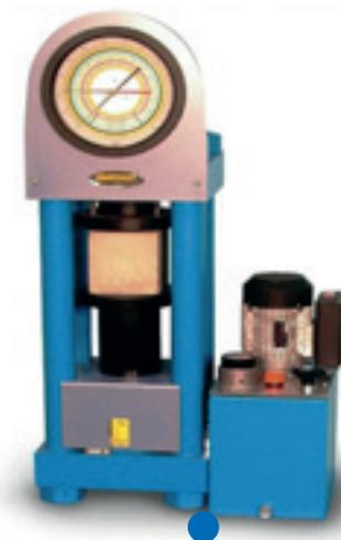
**Pressa di compressione:** utile nel testare la resistenza a compressione di provini di conglomerato bituminoso.
