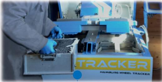
**Macchina ormaiola a doppia ruota:** utile per determinare la suscettibilità alla deformazione delle pavimentazioni bituminose, con creazione di ormaie, in conformità alla normativa UNI EN 12697-22
