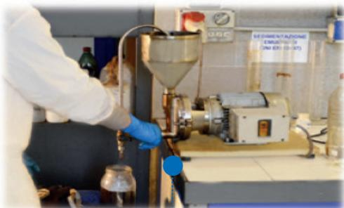
**Mulino colloidale:** necessario per la produzione e lo studio di emulsioni bituminose.
