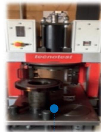
**Compattatore Marshall:** necessario per la preparazione di provini di conglomerato bituminoso per progettazione e prove di miscele bituminose, in conformità alla normativa ASTM D1559
