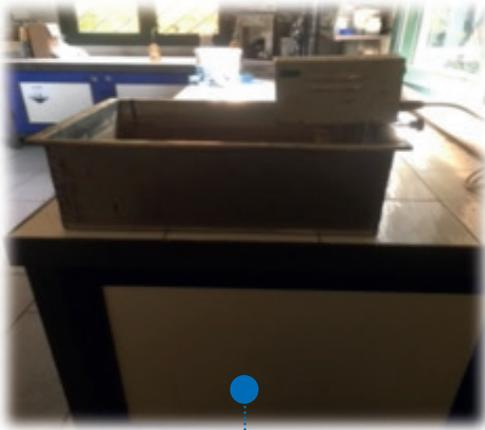
**Bagno termostatico aperto ad acqua:** utile nella preparazione di campioni da sottoporre a prova di penetrazione, o a prove in genere ad una specifica temperatura.
