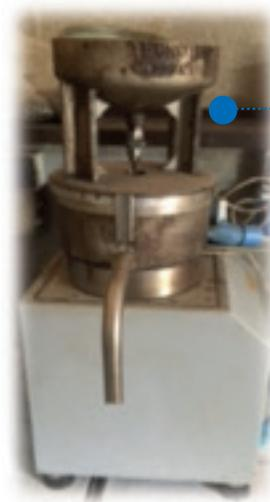
**Centrifuga estrattrice a flusso continuo:** necessaria per l'estrazione del bitume a freddo e la separazione delle particelle minerali (filler, fibre, ecc), in conformità alle normative UNI EN 12697-1 e ASTM D2172.
