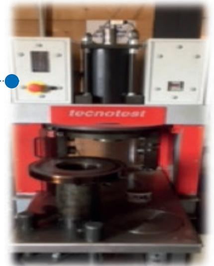
**Cella meccanica di carico Marshall:** necessaria per la determinazione dei parametri meccanici delle miscele bituminose: determinazione della sensibilità all'acqua dei provini UNI EN 12697-12, determinazione della resistenza alla trazione indiretta UNI EN 12697-23, prova Marshall UNI EN 12697-34, test della lama MTO LS289.
