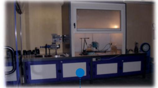
**Cappa con aspirazione per l'evacuazione dei fumi tossici:** necessaria per la manipolazione di sostanze volatili o in presenza di fumi/gas dovuti alle alte temperature.
